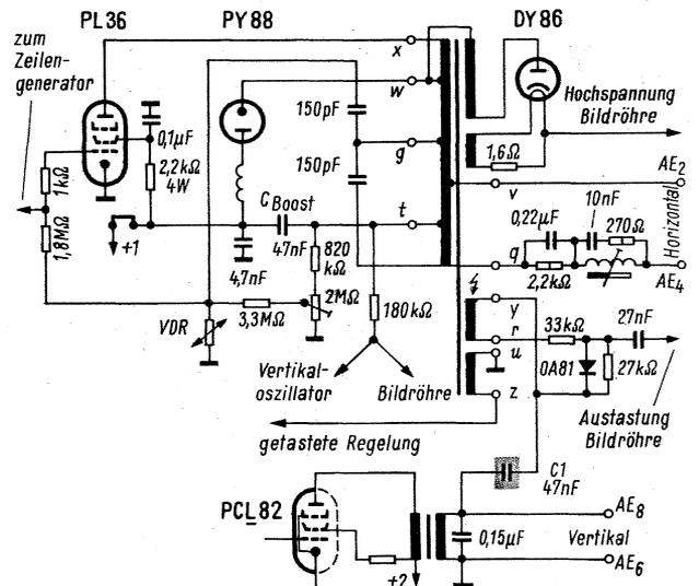
Durch den Wicklungsschluß im Zeilentransformator zwischen q und y gelangte die Boosterspannung auf den Kondensator C 1 und zerstörte ihn, wodurch die Primärwicklung des Zeilentransformators auf Masse gelegt wurde
