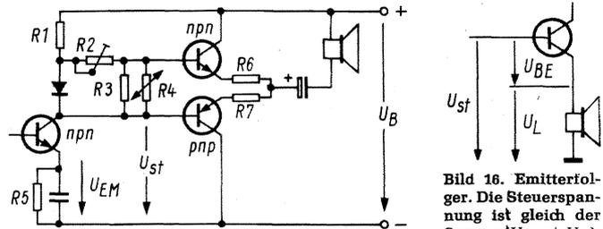
Bild 15. Schaltung für eine komplementäre Endstufe
