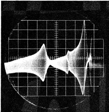
Bild 1. Resonanzkurve eines einwandfreien Zeilentransformators ohne Ablenkeinheit
