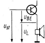
Bild 16. Emitterfolger. Die Steuerspannung ist gleich der Summe ( $U_{BE} + U_L$ ), also starke Gegengekopplung durch den Spannungsabfall am Lastwiderstand
