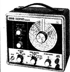
Der volltransistorisierte AM-Meßsender erzeugt Grundfrequenzen von 100 KHz-54 MHz. Das Gerät hat Feinabstimmung und eine übersichtliche Skala. Sämtliche Bedienungsteile befinden sich auf der Frontplatte. Der Modulationsgrad kann verändert werden, ebenfalls besteht die Möglichkeit das NF-Signal regelbar zu entnehmen oder das Gerät fremd zu modulieren.
