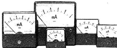
Qualitäts-Drehspul-Einbaumeßinstrumente mit Nullpunkt-Korrektur Klasse 2,5. Industriegraue Abdeckung. Amperemeter 50 µA—15 A, Voltmeter 6 V—300 V. Nullpunkt-Mittelstellung auch in 50 µA und 100 µA. Flanschgrößen: quadratisch 44/51/60/80/100 mm. Gehäusegrößen: Durchmesser 38/45/52/65/85 mm.
