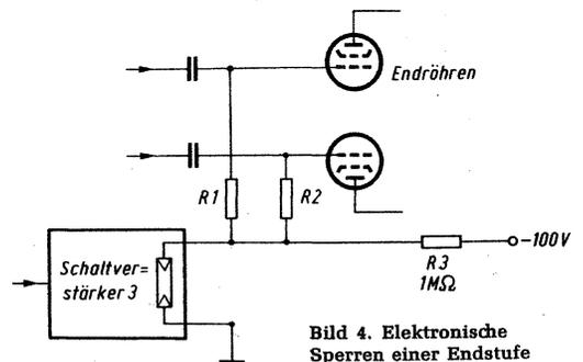
Bild 4. Elektronische Sperren einer Endstufe
