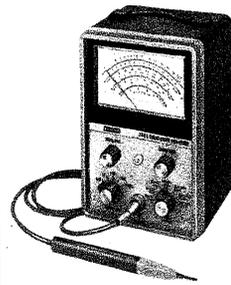
Auf Grund seines hohen Eingangswiderstandes ist dieses vielseitige Gerät für viele Service-Arbeiten gedacht. Die Vorteile sind: FET-Eingangverstärker, Universalumschaltspitze, je 7 Meßbereiche auf Wechselspannung, 7 auf Gleichspannung und 7 für Ohmmessungen. Das Gerät hat ein eingebautes stabilisiertes Netzteil, kann aber auch auf die eingebauten Batterien umgeschaltet werden und ist somit unabhängig von der Netzspannung.
