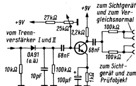
Bild 13. Misch- und Differenzfrequenz-Verstärkerstufe zu Bild 9
