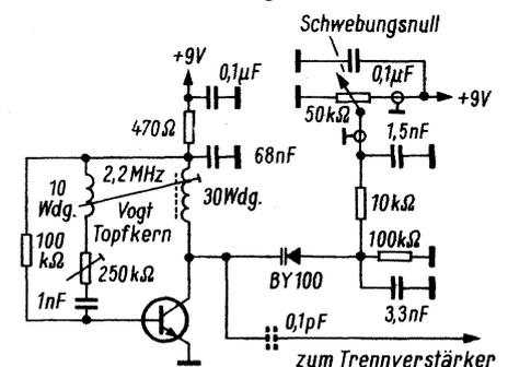
Bild 10. 2,2-MHz-Festoszillator (Oszillator I) zu Bild 9
