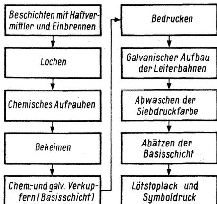
Bild 1. Prinzipieller Arbeitsablauf des beschriebenen Additivverfahrens
