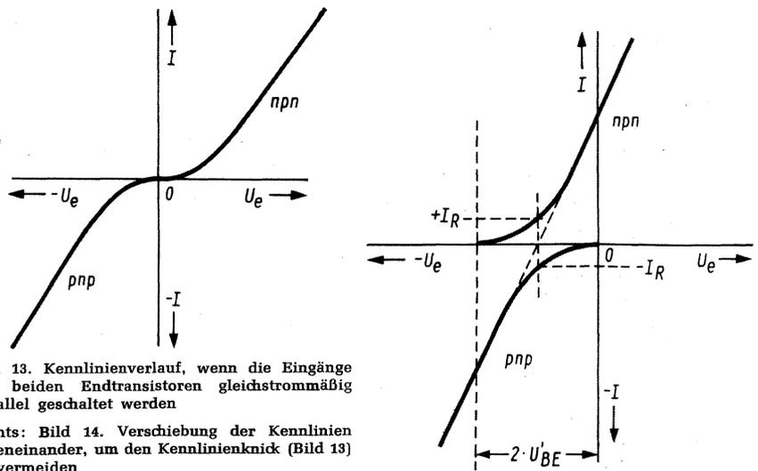
Bild 13. Kennlinienverlauf, wenn die Eingänge der beiden Endtransistoren gleichstrommäßig parallel geschaltet werden
