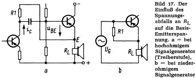
Bild 17. Der Einfluß des Spannungsabfalls an  $R_L$  auf die Basis-Emitter-Spannung. a = bei hochohmigem Signalgenerator (Treiberstufe), b = bei niederohmigem Signalgenerator
