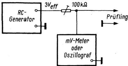
Bild 7. Resonanzprüfung mittels RC-Generator
