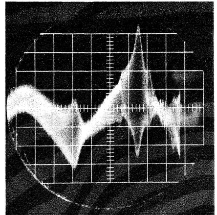
Bild 4. Resonanzkurve eines einwandfreien Zeilentransformators, Boosterkondensator ist unterbrochen
