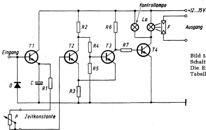
Bild 5. Schaltung des Schaltverstärker-Bausteines. Die Einzelteile nennt die Tabelle
