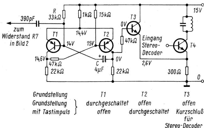
Bild 3. Monostabiler Multivibrator zum Stummtesten des Empfangsteils beim Betätigen der Fingertipp-Elektronik
