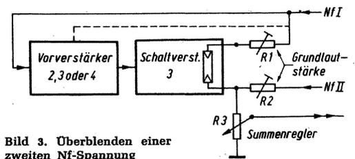
Bild 3. Überblenden einer zweiten Nf-Spannung
