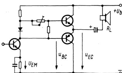
Bild 18. Schaltung zur Berechnung von  $P_{C \max}$
