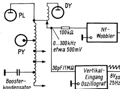
Bild 3. Blockschaltbild zur Aufnahme der Resonanzkurven gemäß Bild 1, 2, 4, 5, 6
