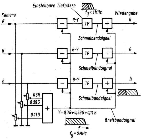
Bild 9. Bildung der Farbdifferenzsignale (R - Y), (G - Y) und (B - Y), ihre schmalbandige Übertragung und die Wiederausammensetzung zu R, G und B durch Addition des breitbandig übertragenen Leuchtdichtesignales (Methode der „mixed highs“)
