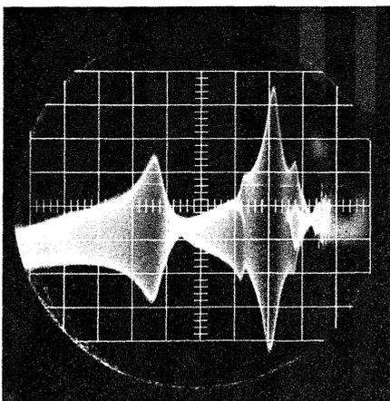
Bild 2. Resonanzkurve eines einwandfreien Zeilentransformators mit Ablenkeinheit
