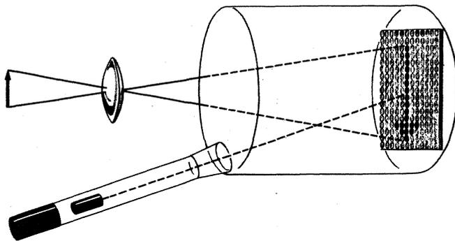
Bild 4. Das Ikonoskop von Zworykin. Die erste Fernsehaufnahmeröhre war dem Menschenauge nachgebildet
