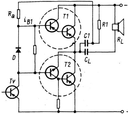
Bild 9. Vereinfachung von Bild 8, um die Aufstockung der Kollektorspannung des Treibers deutlich zu machen
