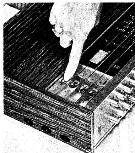
Bild 1. Die Fingertipp-Senderwahltasten beim Hi-Fi-Stereo-Steuergerät RH 790 (Philips)
