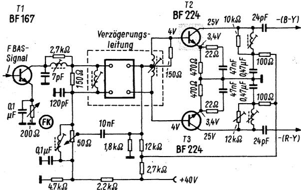
Bild 1. Der Transistor T 2 hatte einen Basis-Emitterschluß
